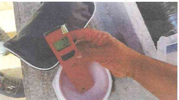
Actividad No. 10: Monitoreo de cloro Residual, en los sistemas de agua potable del municipio de San José Chacayá.
